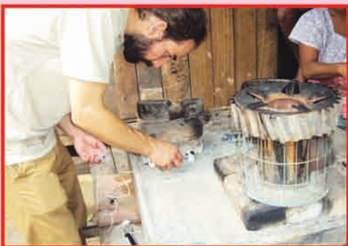
Gasifier မီးဖိုတွင် Thermocouple data logger တပ်ဆင်ပေးထားပုံ
