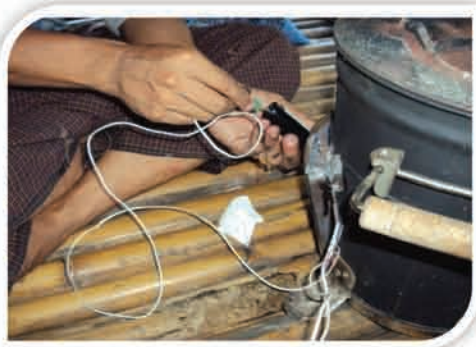
အသုံးပြုအဝမ်းမီးဖိုတွင် Thermocouple data logger တပ်ဆင်နေပုံ
