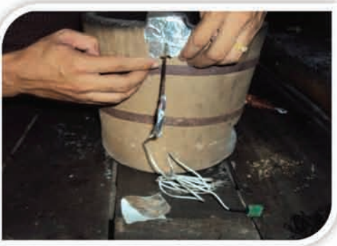
အသုံးပြု Envirofit M5000 မီးဖိုတွင် Thermocouple data logger တပ်ဆင်နေပုံ
