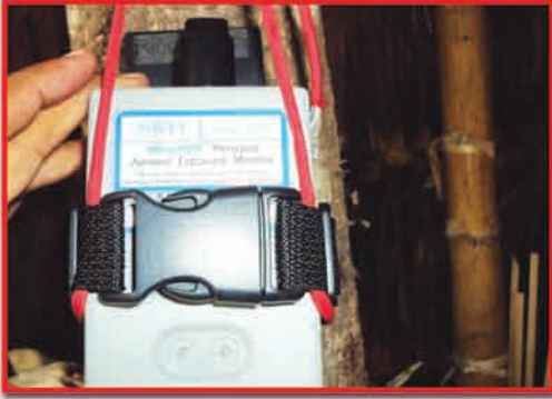
Micro PEMS Pm Sampler မီးဖိုချောင်အတွင်းနံရံတိုင်တွင် တပ်ဆင်ပေးထားပုံ
