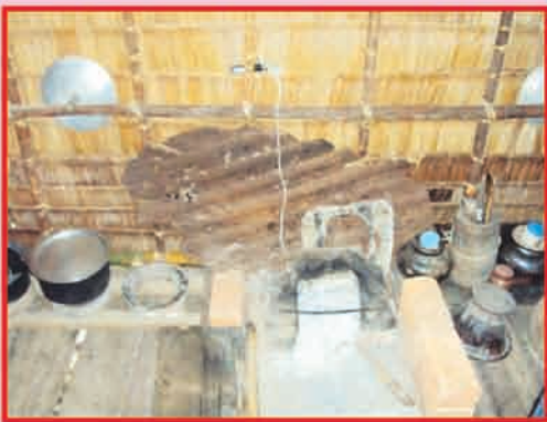
ရိုးရာဖိုခနောက်မီးဖိုတွင် Thermocouple data logger တပ်ဆင်ပေးထားပုံ
